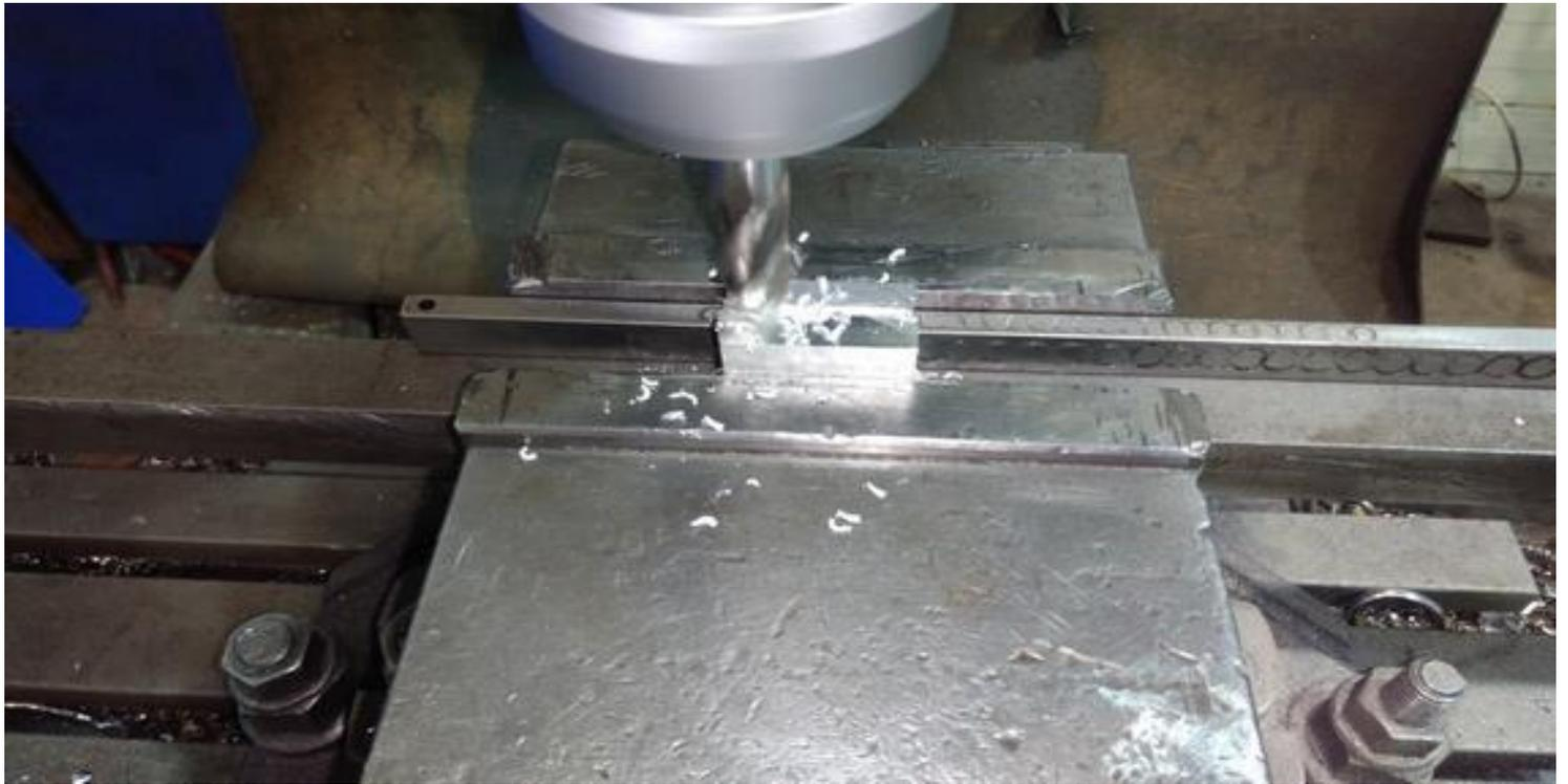
Зажав в тиски фрезерного станка, подравниваю и довожу до нужного размера куски алюминия.
