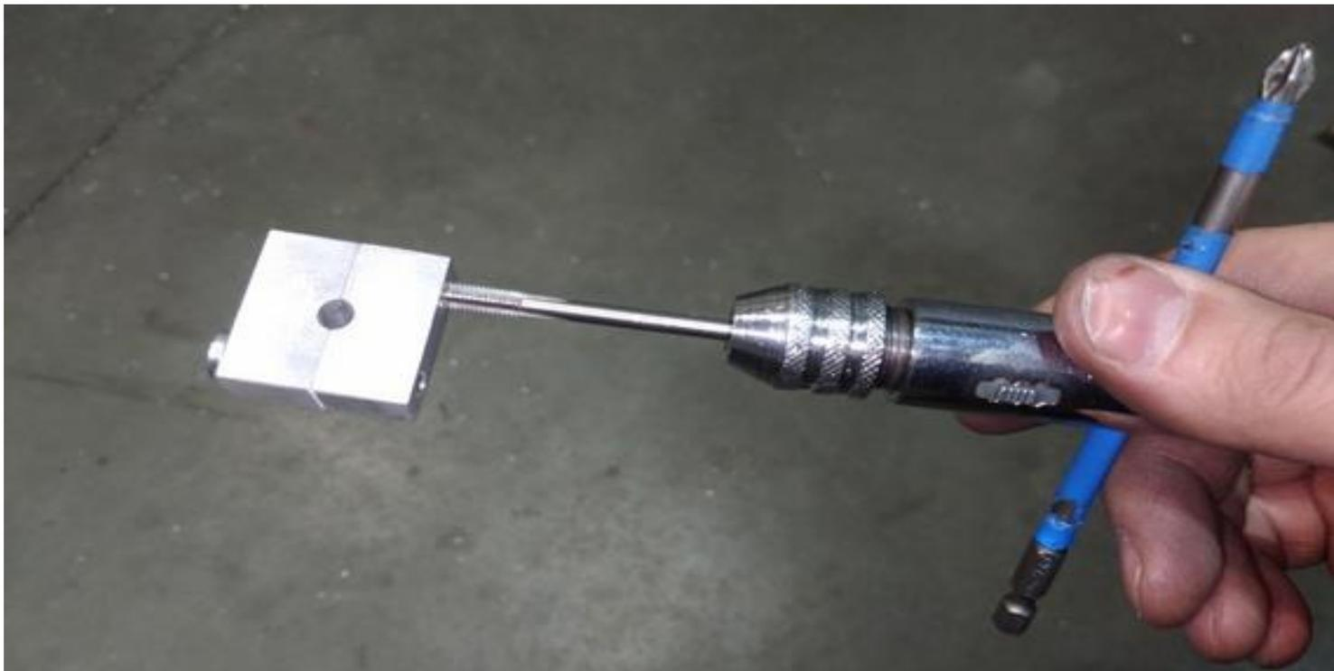
Нарезаю резьбу метчиком М4 и скрепляю болтами две половинки.
