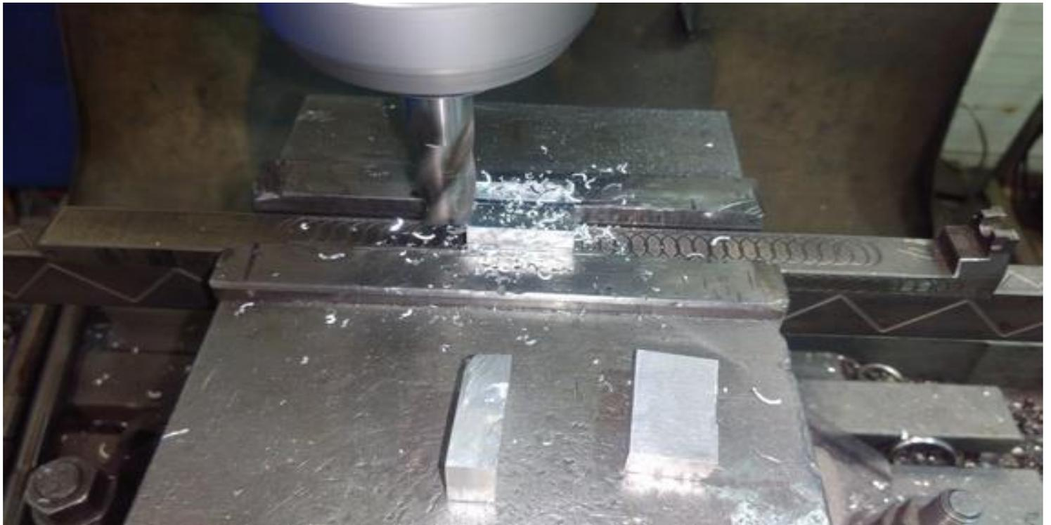
На фрезерном станке довожу до размера 15 мм.
