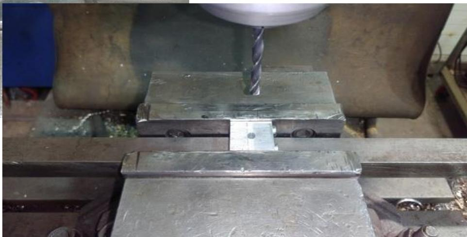
Зажав во фрезер намечаю центр отверстия точно по стыку двух половинок. Сверлю отверстие 6 мм.
