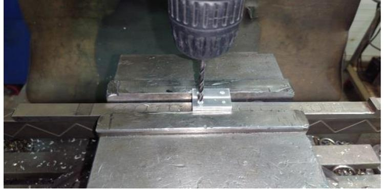
Намечаю центровочным сверлом будущие отверстия. И сверлом 4 мм сверлю верхний брусок, а сверлом 3.3 мм нижний брусок.
