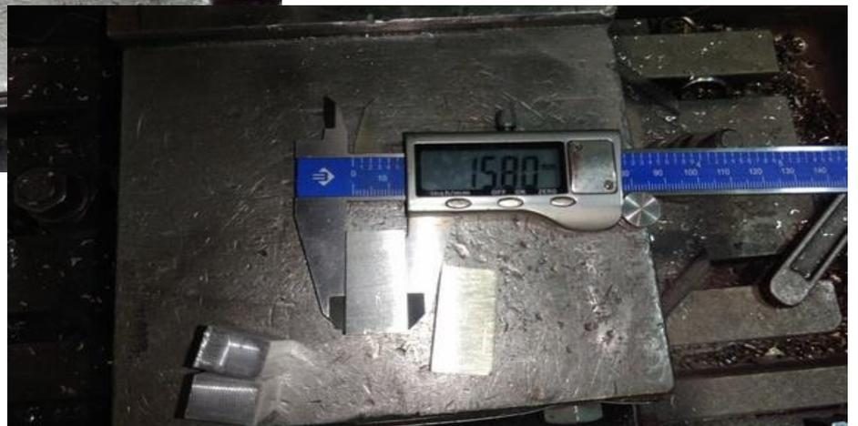
Нижний брусок до точного размера 15 мм, а верхний до примерного 16 мм.
