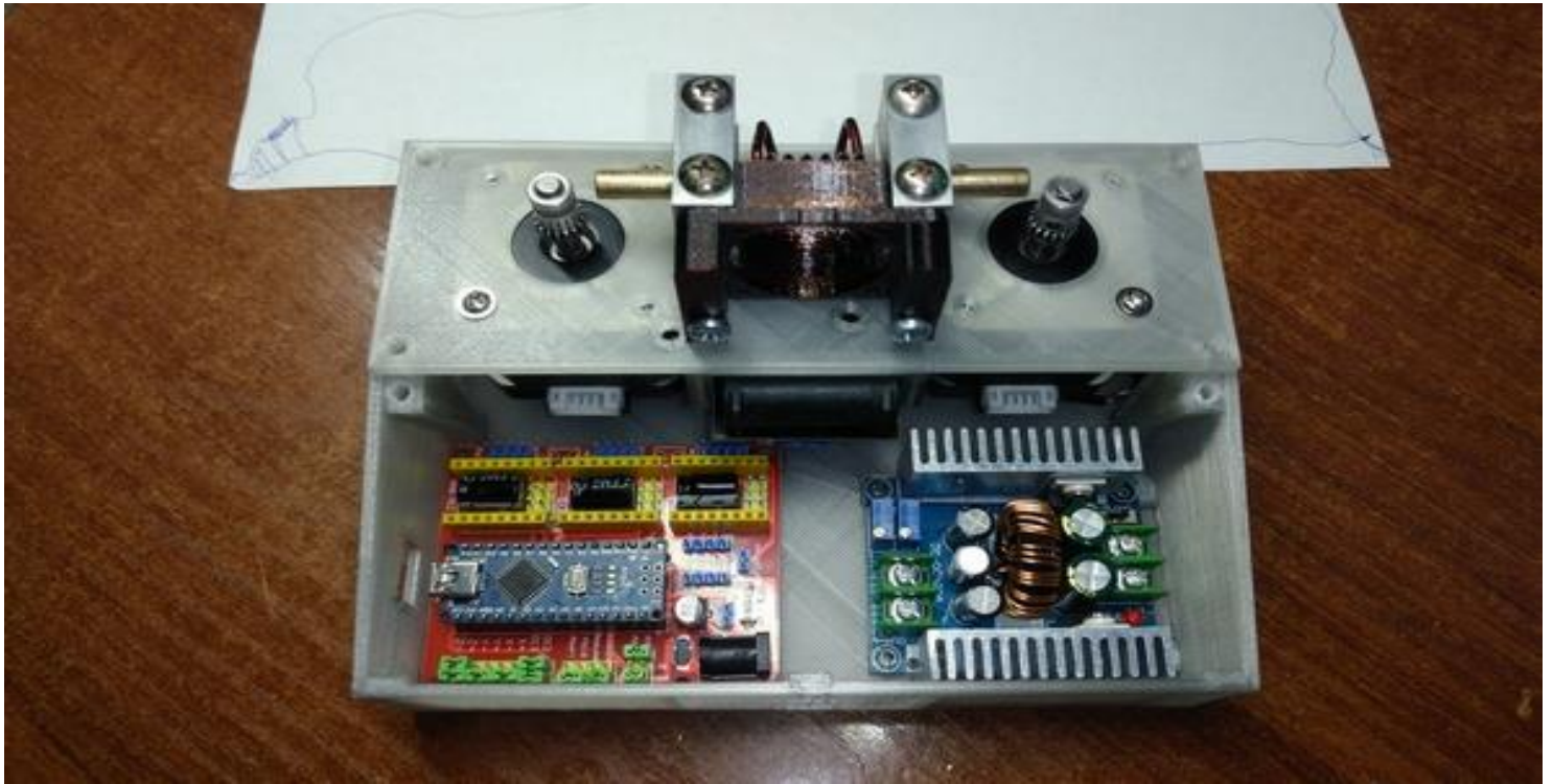
Примеряю расположение плат. Прикручиваю DC-DC преобразователь.
